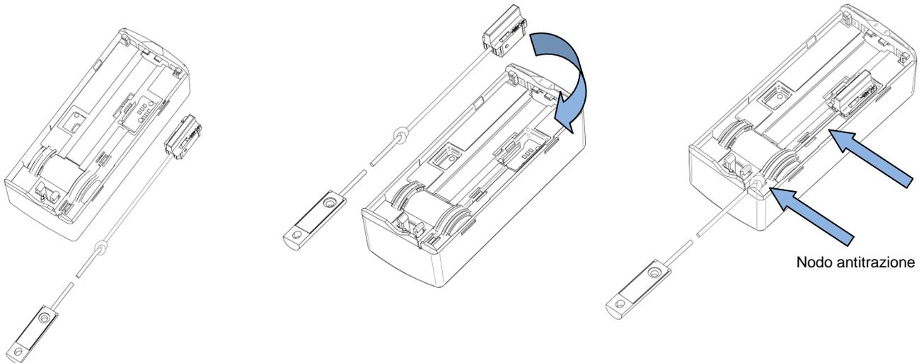
Girare il ripartitore e inserire il connettore del sensore remoto nell'interfaccia all'interno del ripartitore.
